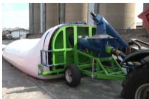
Abb. 12: Einlagerung von Getreide mit Farm Bagger und Befüllschnecke
