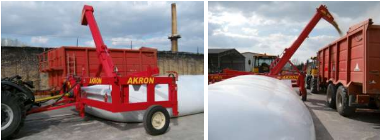
Abb. 6: Spezial-Entnahmetechnik für Getreide aus dem Folienschlauch
